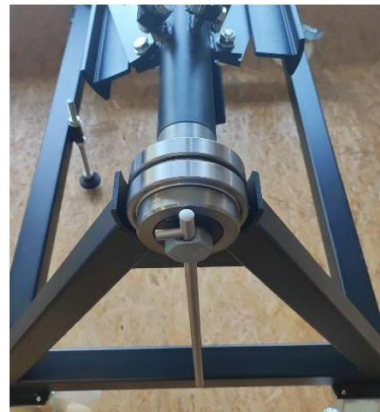
Spindel zum Verstellen des Spreizdorns
