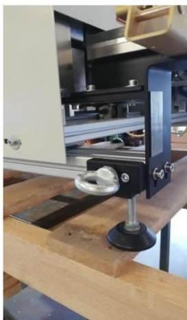
Kranöse und verstellbarer Fuss
