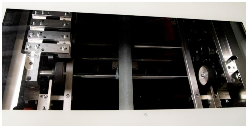
Profiliereinheit mit großen Rollen
