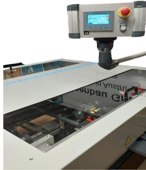
Schwenkbarer Steuerungsarm für allseitige Bewegung und modernstes Touchscreen Display – Made by Siemens
