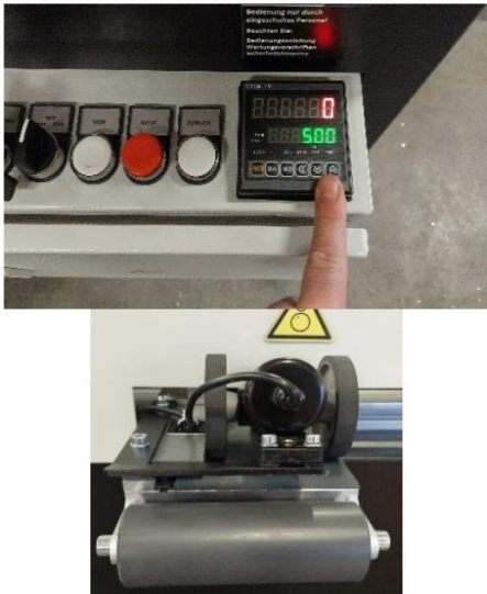
Biegeeinheit und Clipreliefmodul
