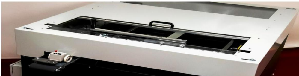
Abgesicherte Schubladenführung für händischen Eingriff
