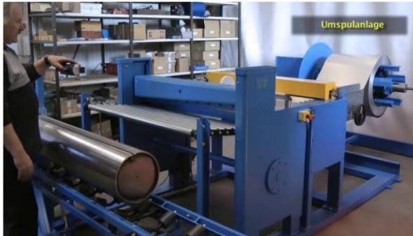
Einführen des Bleches in den Ablängprofi bzw. Spaltanlage
