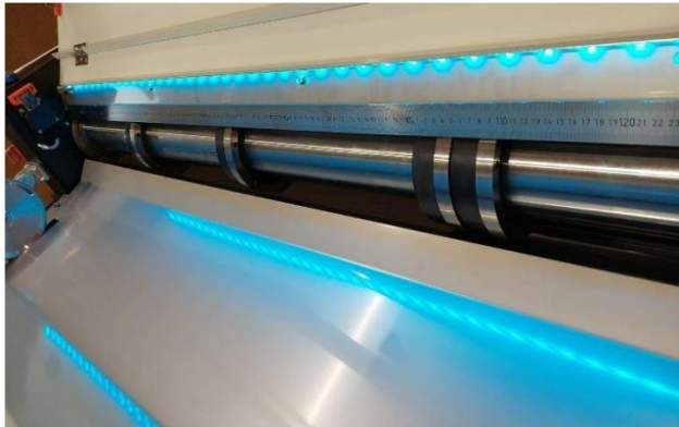
Messerwellen, Spaltmesser (verstellbar) sowie Maßband zum zur Spaltbreiteneinstellung
