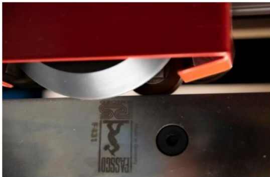
Blech eingespannt mittels Anschlag oder Klemmvorrichtung
