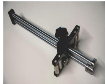
Leichtbauweise – Aluminium (Rostfrei) und Umformung über gehärtete Lager
