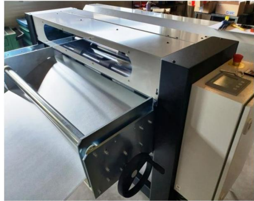
Breitenverstellrad am Blecheinlauf
