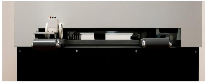
Sichtfenster und Querteilschneideeinrichtung
