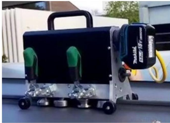
Separate Hebel für Winkel – und Doppelstehfalz
