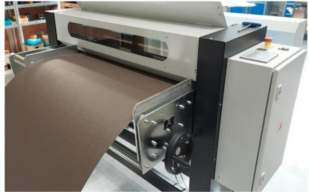
Blecheinlauf der Spaltanlage (mit verstellbarer Führungsbreite)
