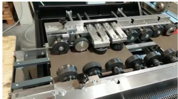
Profilierereinheit mit optionalem Biege- und Clipreliefmodul
