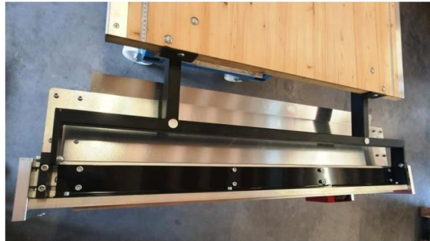
Große Bauhöhe unter dem Niederhalter
