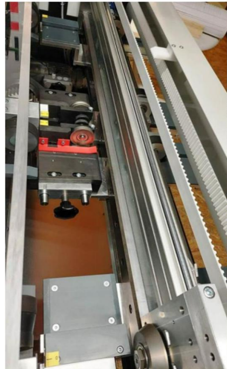
Vollautomatische Schere (Querteilung) mit abgesicherter Eingreifmöglichkeit
