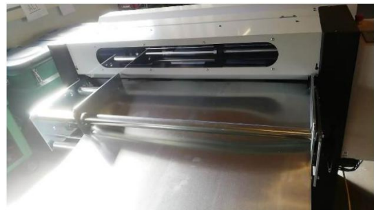
Blecheinzug per Handrad seitlich verstellbar
