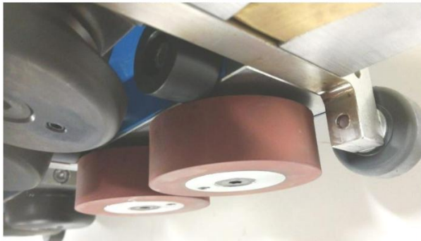
Kompletter Rollensatz (Profilier Rollen gehärtet)
