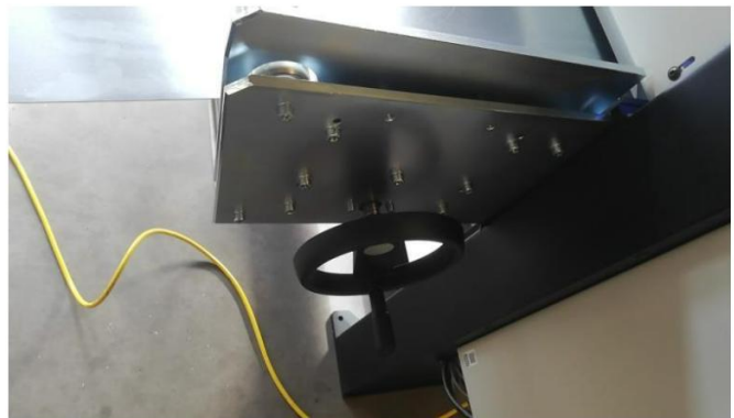
Breitenverstellrad am Blecheinlauf
