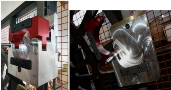
Quickfix für die Haspeln(geschlossen/offen)
