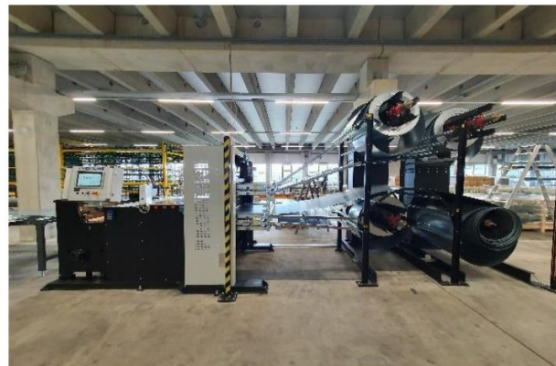
SP1250TS optional mit Geradrichter und mit Materialverwaltung (4 x 3t-Coils)
