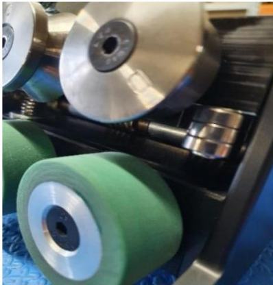
Stabilere Halterung des Akku-Schraubers Verstellbare Räder für 25, 32 und 38 mm
