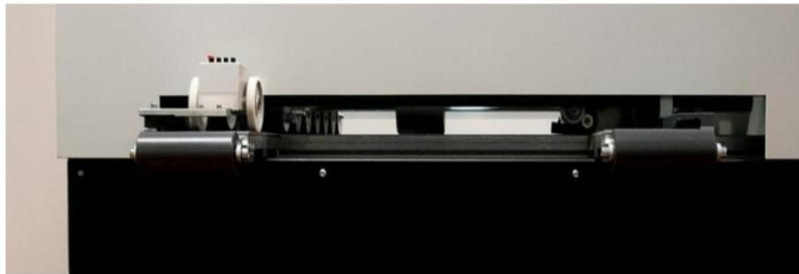
Einlauf (Blecheinzug) von vorn
