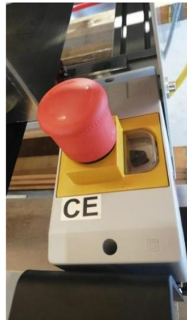
Ein/Aus-Schalter und Not-Aus (abnehmbar)
