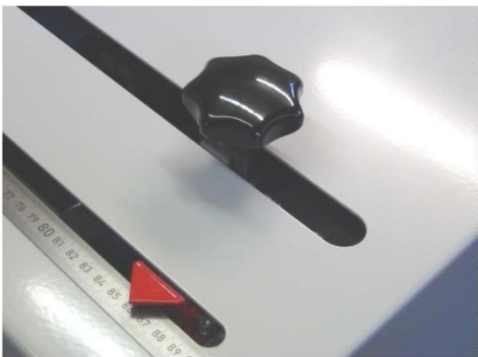
Einfache Breitereinstellung mit Quickstep-System
