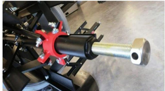
Vorrichtung für die Spannkurbel des Spreizdornes
