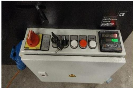
Bedienpult und mechanische Kupplung für automatischen Einzug
