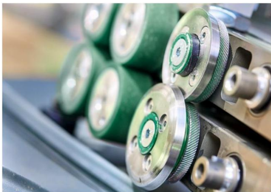
Mit Schneidrollen (Option)
