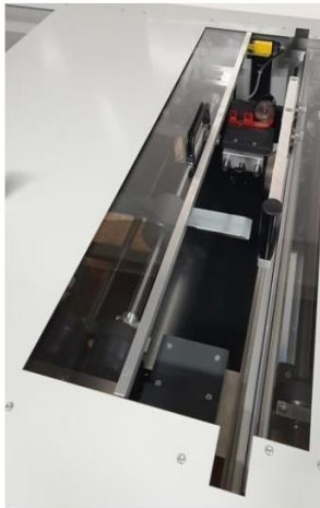
Sichtfenster und Querteilschneideeinrichtung
