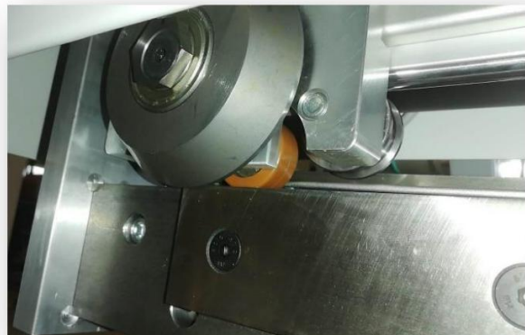
Schneidschlitten mit Untermesser
