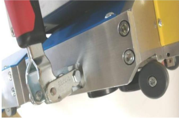
Klemmmechanismus mit Handgriff
