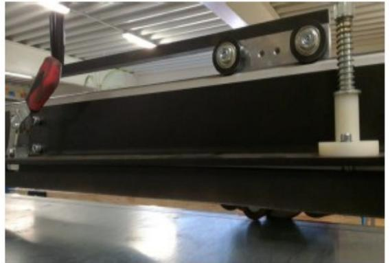
*Blech eingespannt mittels Anschlag
