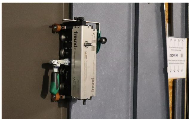
Mit Schneidrollen und Sicherungsschraube
