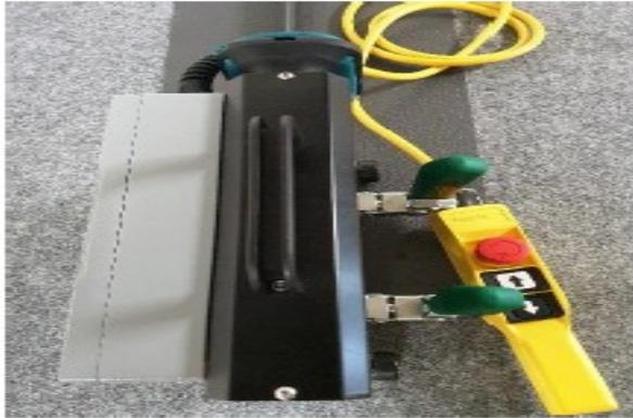
*Separate Hebel für Winkel - und Doppelstehfalz*
