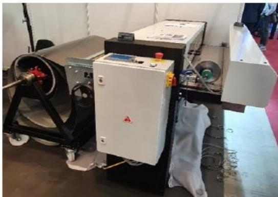
*Blecheinlauf der Anlage (mit verstellbarer Führungsbreite)*
