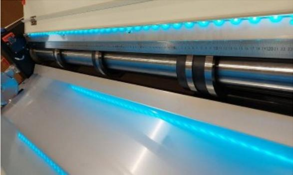
Blecheinlauf der Spaltanlage (mit verstellbarer Führungsbreite)
