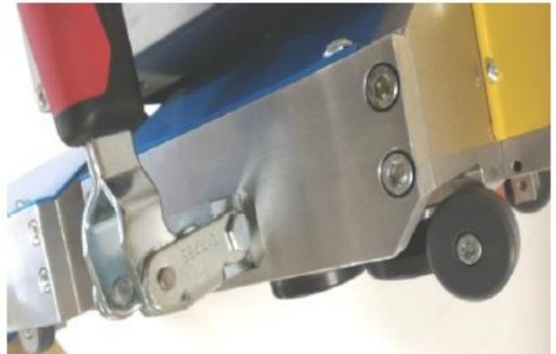
*Kompletter Rollensatz (Profilier Rollen gehärtet)*
