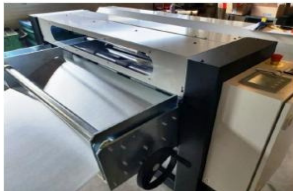
Breitenverstellrad am Blecheinlauf
