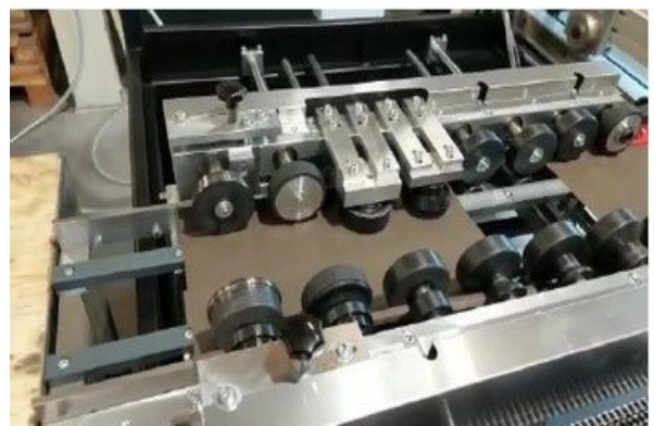
Profiliereinheit mit optionalen Biege- und Clipreliefmodul
