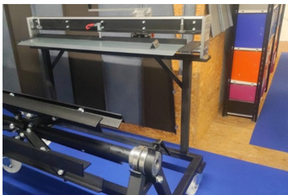
Abrollhaspel mit ausgefahrenem Gestell zum Montieren der Handschere
