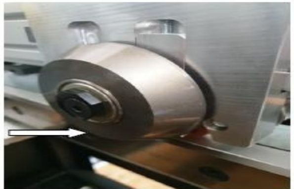
Messereinstellung (Querteil Schneideinrichtung)
