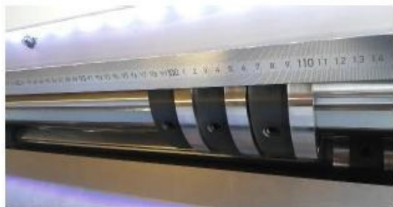
Sicherheitsschalter der Messerwellenhaube
