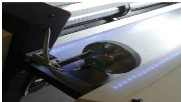
Blecheinzug per Handrad seitlich verstellbar
