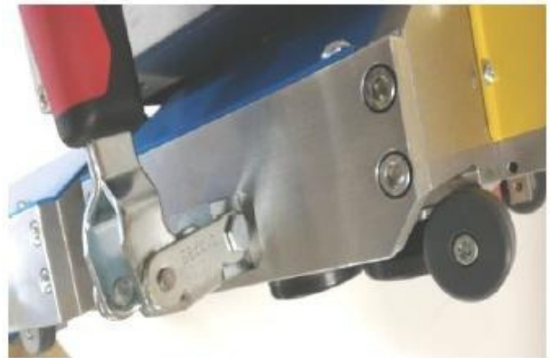
Elektromechanischer Endschalter (nur bei dem Serie Star)
