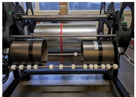
Korb für Blechabschnitte bis zu 600kg (Optional)
