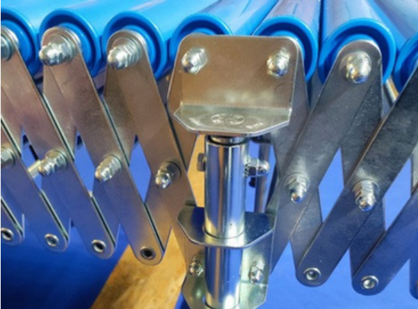
Schließklemmung zur Höhenverstellung
