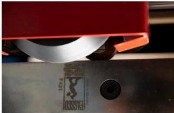
Ansicht: Untermesser, Obermesser und gummierte Andrückrolle
