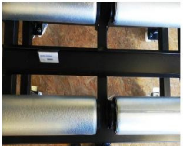
Geteilte Rollen und integrierter Blechklammwinkel
