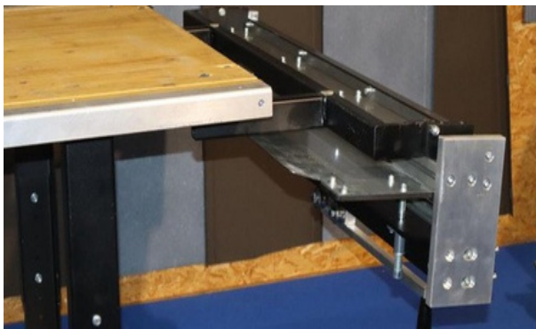
Optional: Mit Handschere in abgeklappten Zustand (integrierter Wendemechanismus)
