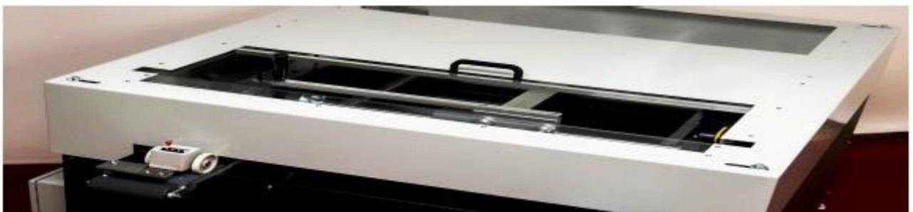
Abgesicherte Schubladenführung für händischen Eingriff
