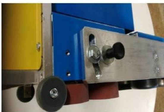
Konkav- und Konvex- Einstellung der Maschine (mittels Druckknopfs)
