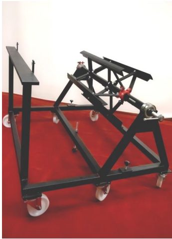
Abrollhaspel mit ausgefahrenem Gestell zum Montieren der Handschere
