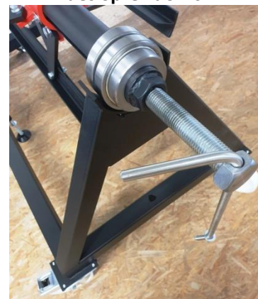
Spindel zum Verstellen des Spreizdorns
