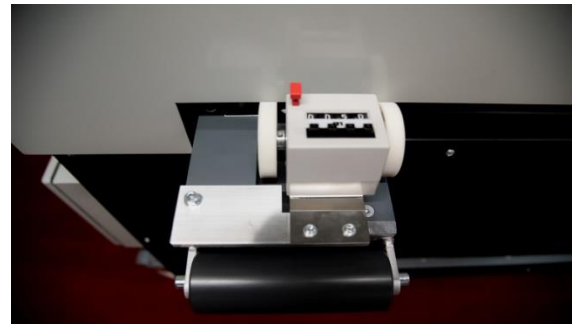
Längenmessung über Messrad
